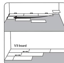
**PLACEZ LA LAME DE STRATIFIÉ (A)** à un angle de +/- 20° par rapport au système de verrouillage en aluminium sur le côté long de la rangée précédente. Positionnez le côté court, directement sur le verrouillage de la lame posée (B). Un clic sonore indique que la connexion du côté court est verrouillée.
