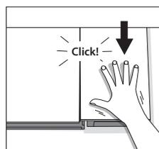
Après l'installation de 3 rangées complètes, faites glisser les lames vers le mur de départ en laissant un joint de dilatation de 4mm minimum. Utilisez les cales d'espacement. Si le mur de départ est irrégulier, les lames de la première rangée seront à ajuster : tracez la découpe sur la première rangée pour reporter les irrégularités du mur et enlevez les lames. Réalisez la découpe puis remettre en place les lames.
