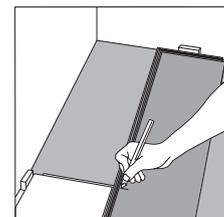
**DÉMARREZ LA RANGÉE 2** les joints d'extrémité doivent être décalés d'au moins 1/3 de longueur de lame. Si le morceau de lame coupée est trop court, recommencez avec une nouvelle lame coupée en deux.
