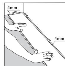
**COMMENCEZ** dans le coin à gauche. Placer la lame avec le système de verrouillage en aluminium face à la pièce et vers la droite. Laissez un espace de 4mm minimum contre le mur. Utilisez des cales qui sont incluses dans **BerryAlloc StartKit**. L'écart entre les lames et le mur de départ pourra être ajusté après l'installation de 3 rangées.
