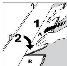
Nous vous recommandons de raccorder le côté court en tapant avec votre poing (ou une cale de frappe et un maillet en caoutchouc), en commençant par le coin intérieur et en allant vers le coin extérieur.
