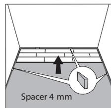
**LA DERNIÈRE RANGÉE** doit faire plus de 5 cm de large. Mesurez la largeur restante en tenant compte du jeu de dilatation de 4mm minimum par rapport au mur de fin. Pour installer les dernières lames découpées, un tire-lame peut être nécessaire.
