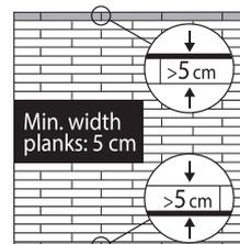
Sens des lames : le résultat est optimal si le sol est installé dans le sens de la lumière (le petit côté faisant face à la lumière).
